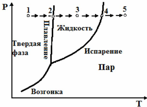
Рис. 3.1. Плоская диаграмма состояния однокомпонентной системы в координатах давление – температура
