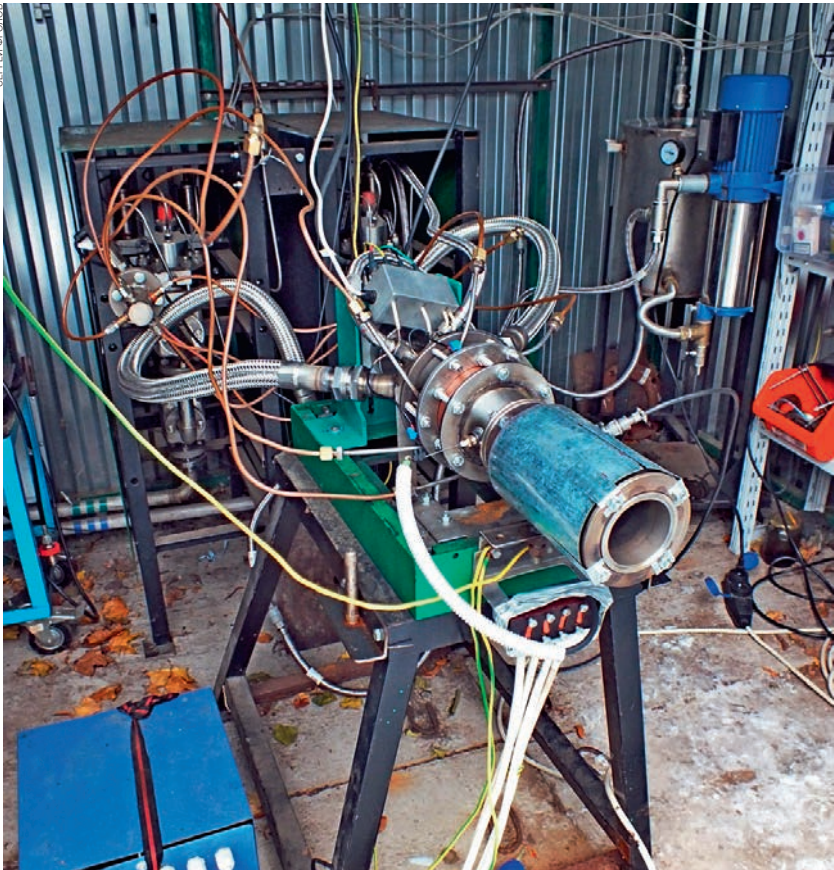
Демонстрационный образец ДРД, установленный на испытательном стенде
