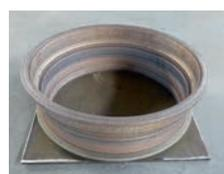
— Образцы деталей, полученных методом лазерного выращивания
